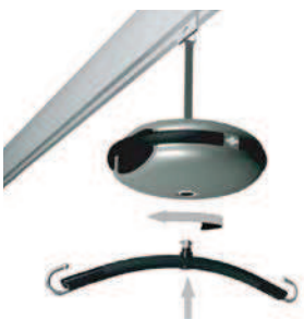
Wieszak z mocowaniem bag- netowym na Lunie. Sprężynowy mechanizm zatraskowy. W celu zamontowania i zdemontowania: wcisnąć. Przekręcić. Zwolnić.
